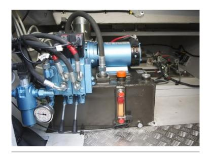
Puisque les leviers hydrauliques fonctionnaient, cela signifiait que le problème était probablement électronique. En vérifiant le système de direction électronique, nous avons réalisé que la position du safran n'était pas retransmise à l'écran et qu'il y avait donc un problème avec le capteur. Victor a vérifié le capteur de gouvernail en suivant les câbles et constaté une connexion lâche. Le problème était résolu après reconnexion et sécurisation.
